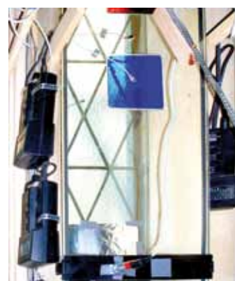
Testscheibe zur Messung der Wirksamkeit der Schutzverglasung
