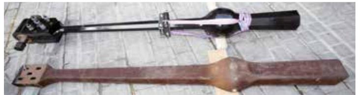
Aus diesem Grund erhielt die Pummerin 2011 einen neuen Klöppel mit einem Gewicht von 613 kg eingebaut, welcher durch die veränderte Proportion eine Verringerung der hohen Belastung bewirkt und die Lebensdauer der Glocke maßgeblich verlängert.
